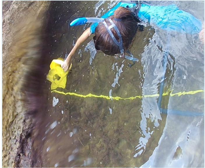
Imatge 4: Col·locació de la cinta mètrica en la nostra zona d'estudi per a crear el transecte. Font: Plàncton.
